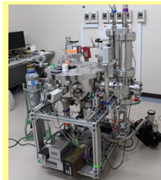
家形先生オリジナルのスパッタ装置は、中にロボアームが入っています。
